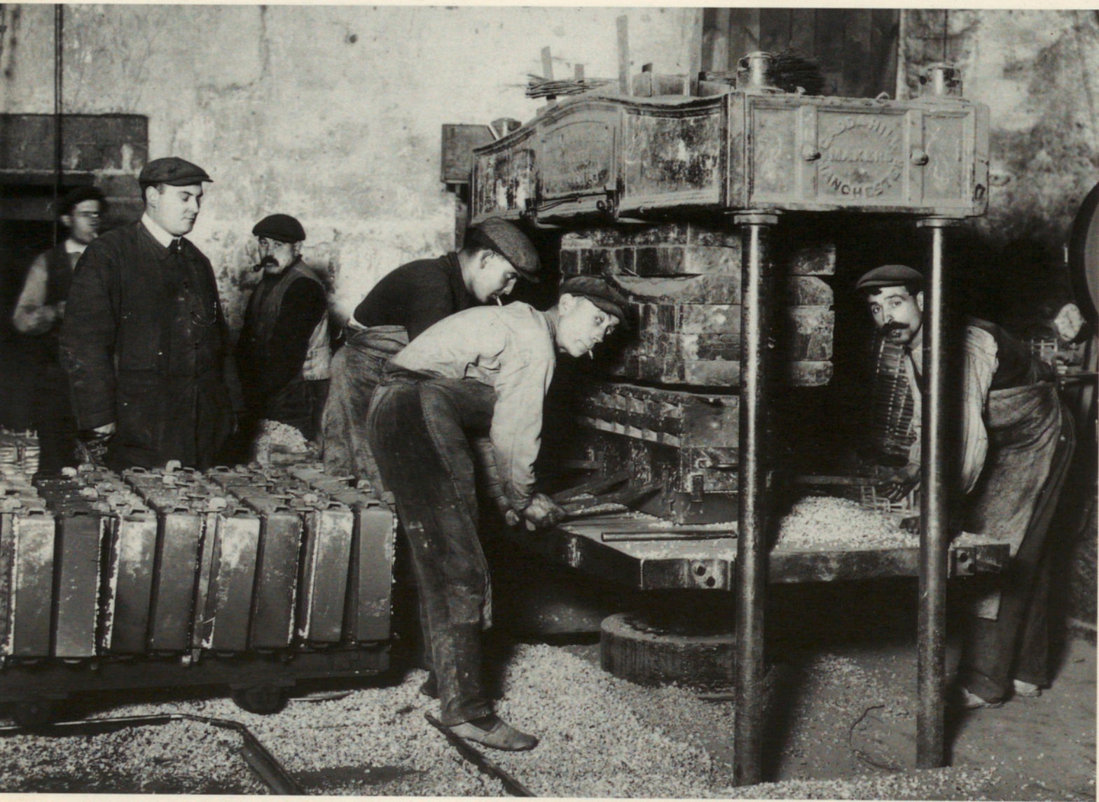
Procés de fabricació d'aglomerats, premsa de mottes i col·locació en vagonetes, 1925 Ricard Mur. Fons de Ricard Mur (reg. 1203)
